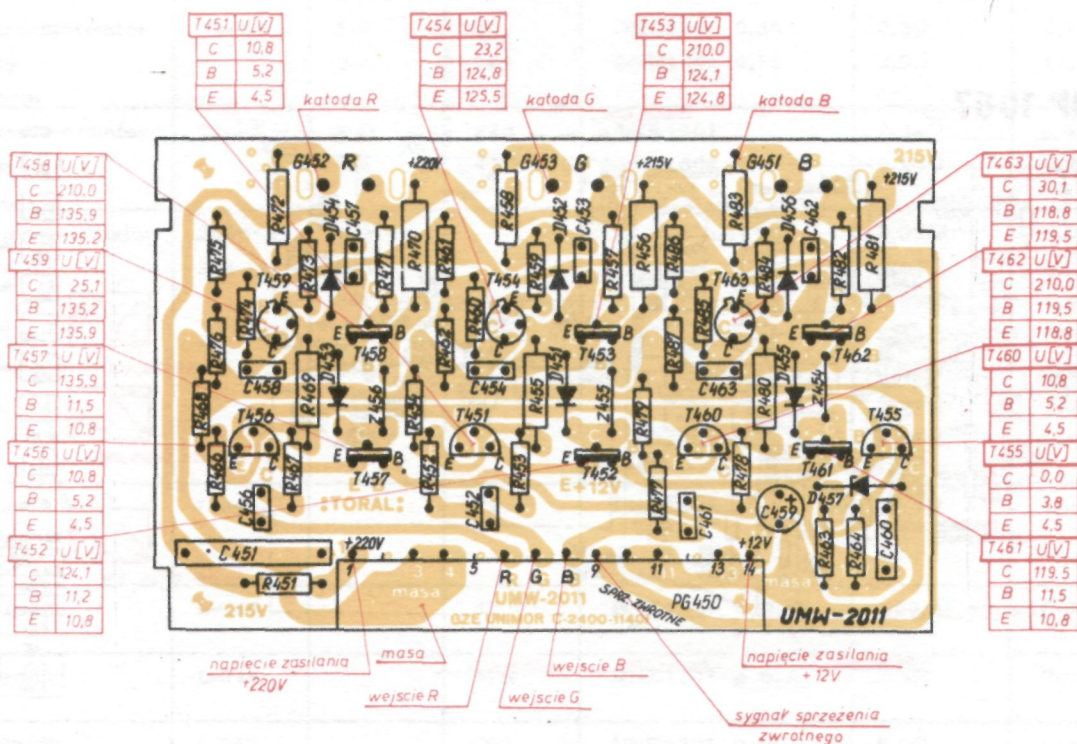
Rys.17.5b. Moduł wzmacniaczy wizyjnych UMW-2011-1 - schemat montażowy. Widok od strony druku.
