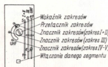
Widok po podniesieniu klawisza zespołu programującego. Gniazda przyłączeniowe znajdują się w tylnej części odbiornika
